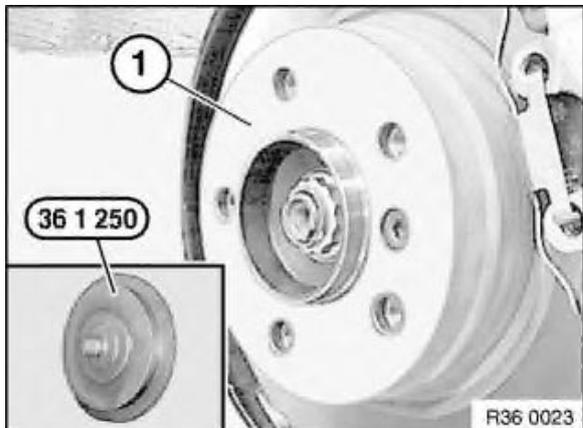
Eliminare tracce di sporcizia, residui di grasso e corrosione dal piano di appoggio (1) con un trapano e l'attrezzo speciale 36 1 250 .
