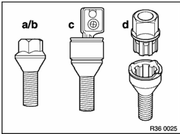
Bulloni ruota con collare conico:
