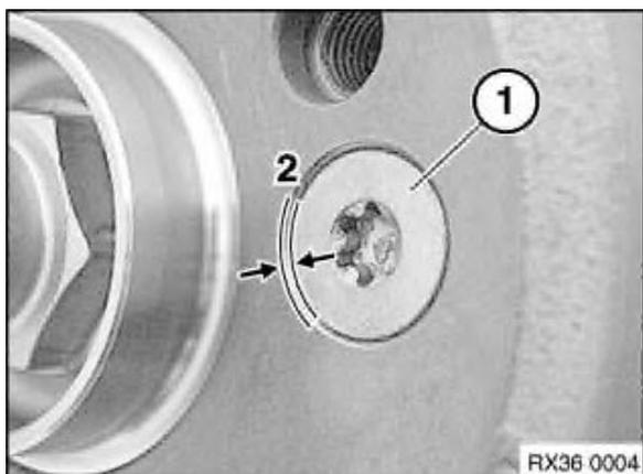
Verificare il fissaggio della vite di ritegno del disco freno (1).
